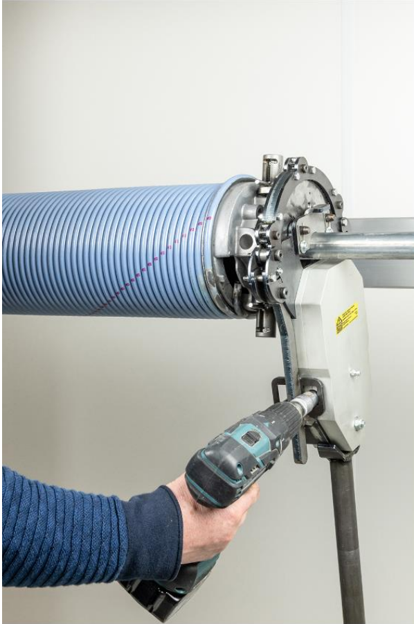
Abbildung 2: Anwendung des Industrial Torqtool mit Hilfe einer Bohrmaschine: Die Feder wird durch die Bohrmaschine und nicht durch manuelle Kraft gespannt.
