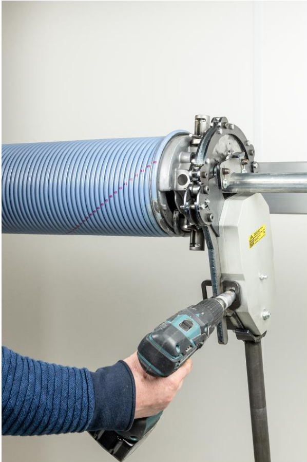
Figure 2 : Application du Industrial Torqtool à l'aide d'une perceuse: le ressort est tendu par par la perceuse et non par une force manuelle.
